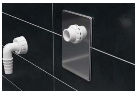
8.Namestiti nerjaveč jeklen pokrov, ga pritrdirti z navojnim obročem ter ročno priviti priključno koleno na navojni nastavek.
