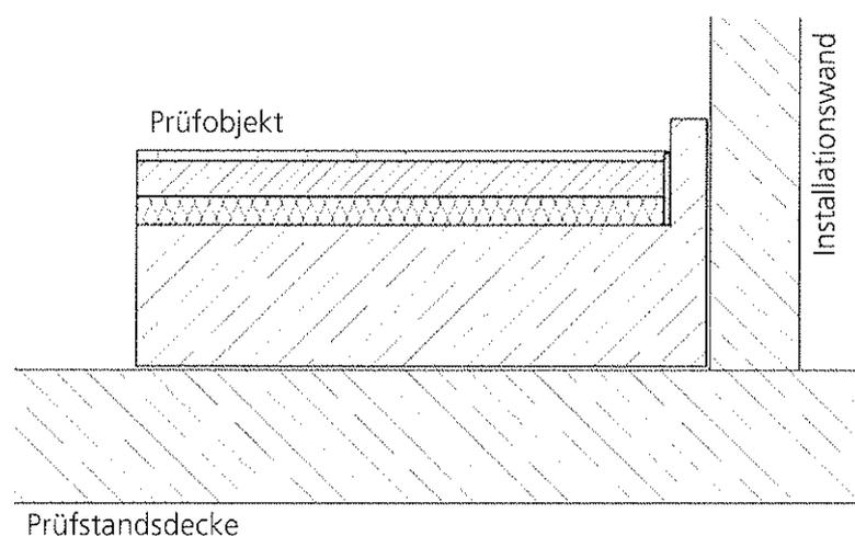
**Bild 1:** Schnittzeichnung des Prüfaufbaus im Installationsprüfstand P12 des IBP (ohne Maßstab).
