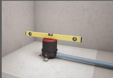
Die Vorteile des neuen Duschablaufs zeigen sich bereits beim Einbau: Stabile Befestigung durch Schrauben an der Rohbetondecke mit integrierten Schallschutz-„Patscherln“. Weiter kann der Grundkörper über Stellwinkel in der Höhe eingestellt werden, um ein Gefälle zum Ablaufrohr zu erzeugen.
