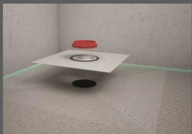
In questo passaggio è possibile installare il kit di impermeabilizzazione direttamente nel corpo di scarico senza utilizzare attrezzi, innesto diretto.
