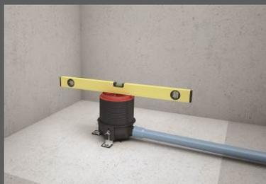
I vantaggi di questo nuovo scarico doccia si notano già dall'installazione: fissaggio stabile al pavimento grezzo tramite viti e piedini in acciaio inox insonorizzati, la regolazione delle viti di fissaggio permette al corpo di scarico di essere dotato già della pendenza necessaria per il collegamento con il tubo di scarico.
