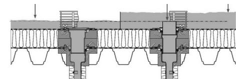
Slika 2: Prikaz sливnika primare (lijevo) i sekundarne odvodnje (desno)
