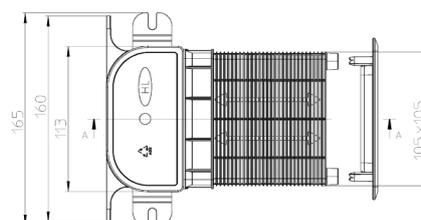
Das neue Unterputz Rohrbelüftungsventil **HL905N/HL905N.0** unterscheidet sich von seinem Vorgänger HL905 durch eine flachere Bauweise. Diese Neuerung ermöglicht den Einbau des Ventils jetzt auch in Trockenbauwände mit 75 mm breiten Ständerprofilen. Die Gesamttiefe des Ventils (165 mm) hat sich nicht geändert. Um diese beizubehalten ist der ablängbare Bauschutz verlängert worden. Das Vorgängermodell wird ab dem 1. Quartal 2021 ersetzt.
