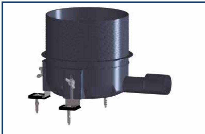
— **Rohbausatz:** Ein großzügiger Ablaufkörper sitzt auf der Rohbetondecke. Das Gefälle zur Ablaufleitung kann mit den Einstellwinkeln justiert werden.
