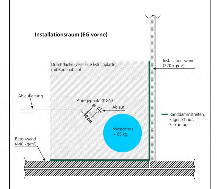
Lage des Prüfaufbaus im Installationsraum (EG vorne).
