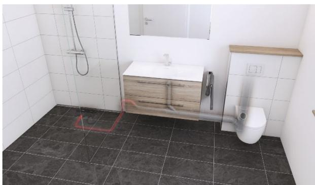
Das modernisierte Bad mit Bodenablaufpumpe und Duschrinne HL54W. Im Untergrund zu sehen die neue Förderleitung (rot) vor der Ablaufstelle bis in die alte Abwasserleitung (grau).
