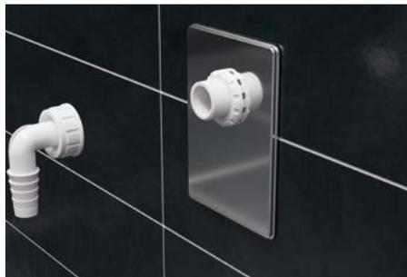
8. Edelstahlabdeckung aufsetzen und mittels Gewindinge befestigen, sowie Anschlussknie handfest auf den Gewindestutzen anschrauben.
