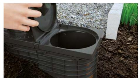
Überschubrohre: Exzentrisch und horizontal stufenlos verstellbar; mit 50mm Überstand, um Dilatationen des Regenrohrs auszugleichen
