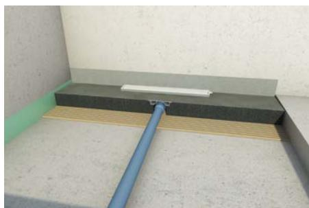
4. Odvod priključiti na instalaciju, provjeriti spojeve.
